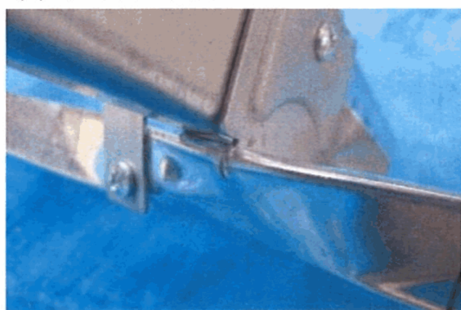
(c) 試験終了後 (野縁損傷部) 【No.1】
