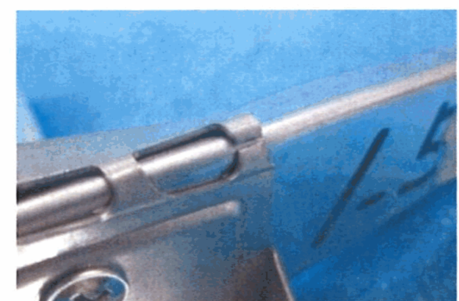
(c) 試験終了後 (クリップ損傷部)
