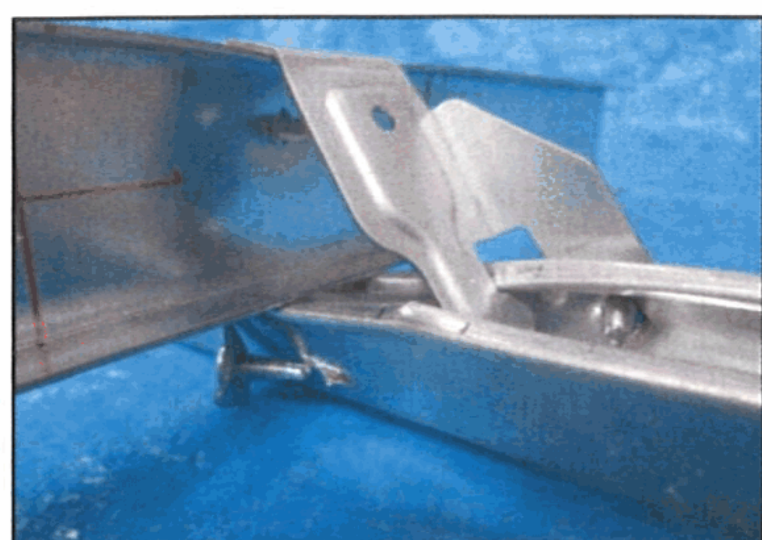
(a) 破壊の状態A（正側）
