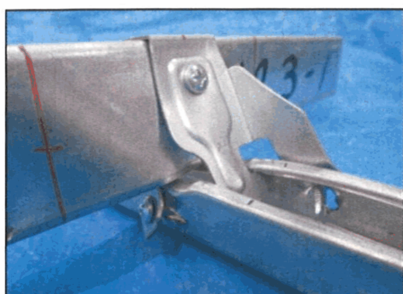
(a) 破壊の状態A（正側）
