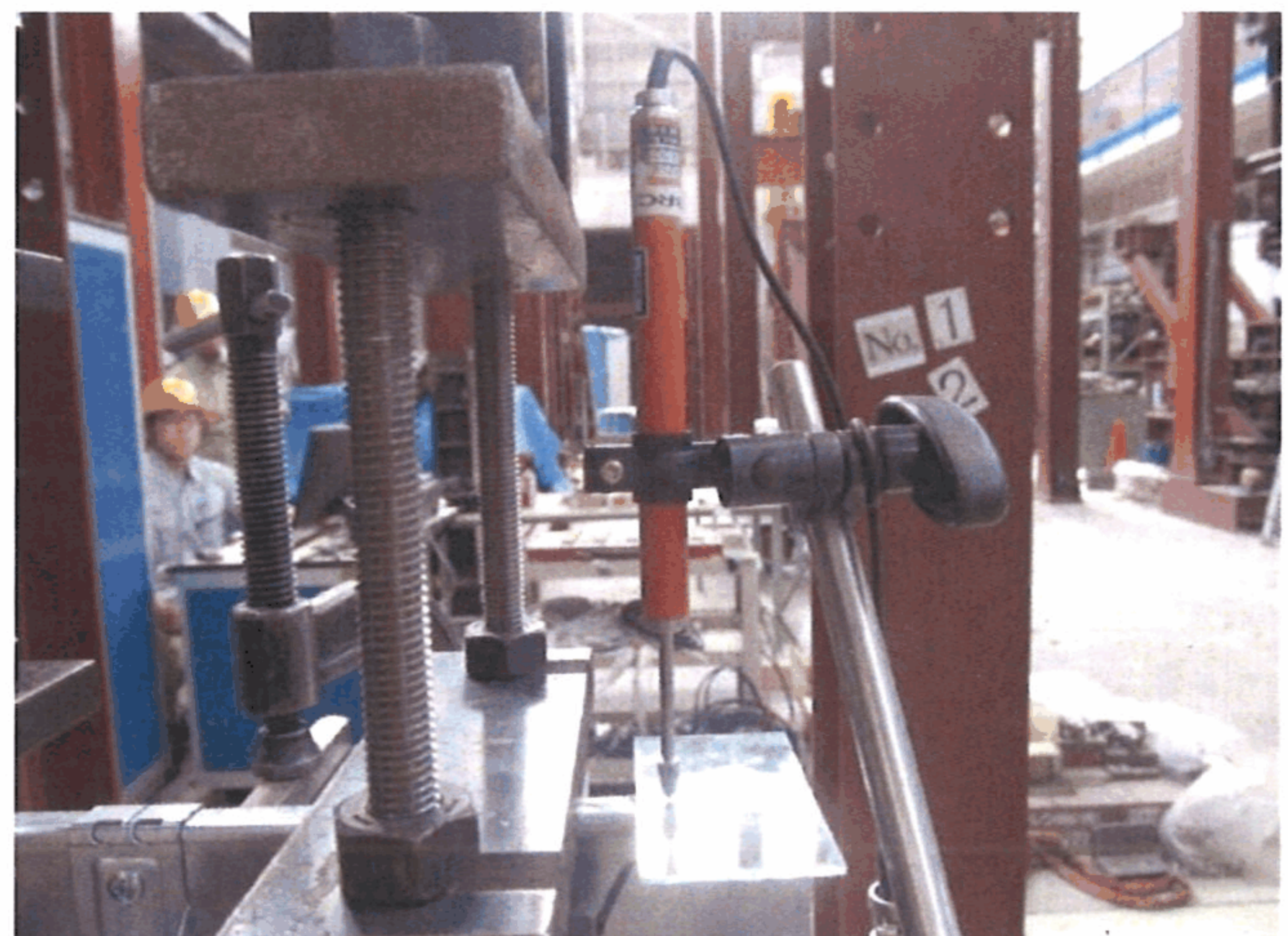
(d) 変位計の設置状況(D.T.2)
