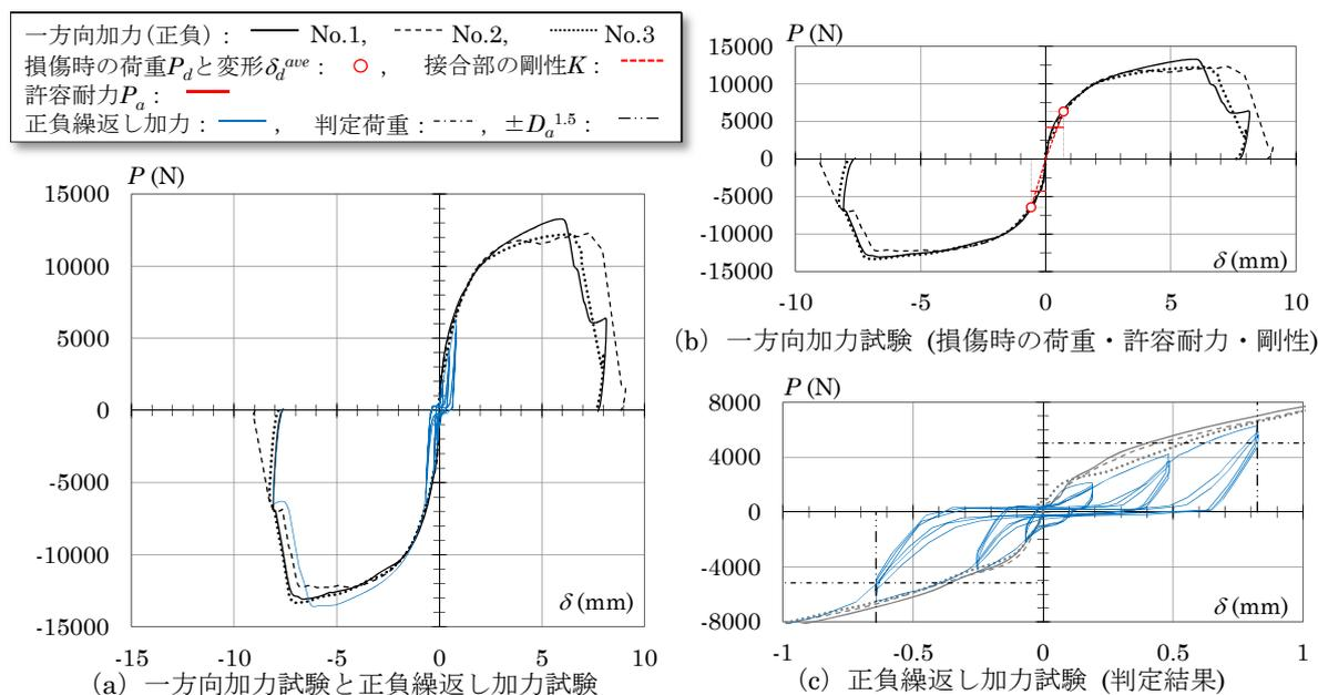
図2.1 荷重 $P$ -変形 $\delta$ 関係 (30度, 評価方法2)
