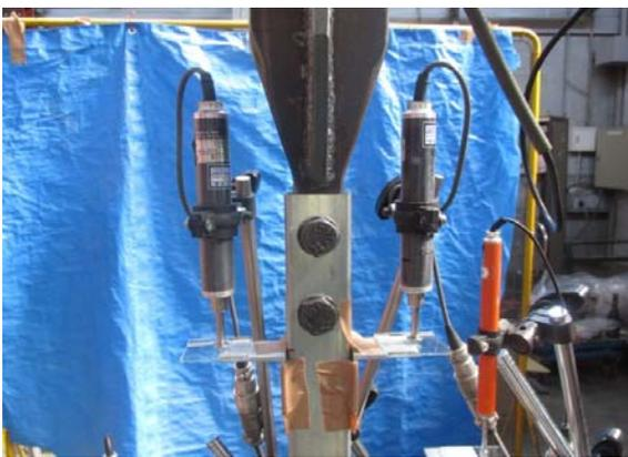
(e) 変位計の設置状況 (D.T.1, D.T.2)
