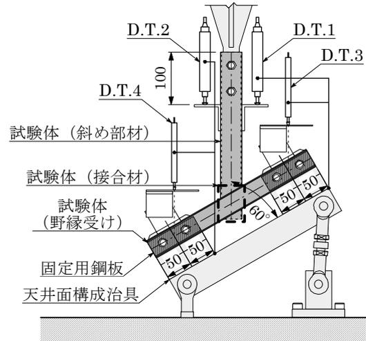
(c) 斜め部材と天井面の角度：60度
