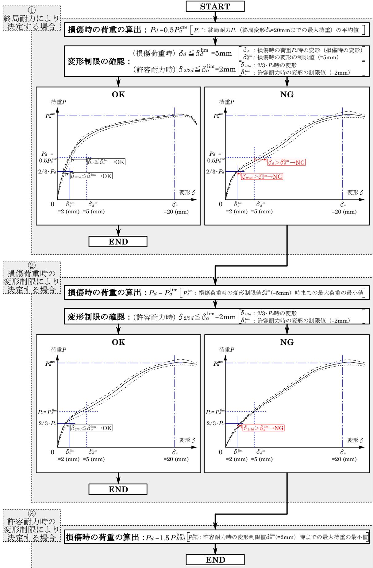
付図 4.1 損傷時の荷重  $P_d$  の算出フロー
