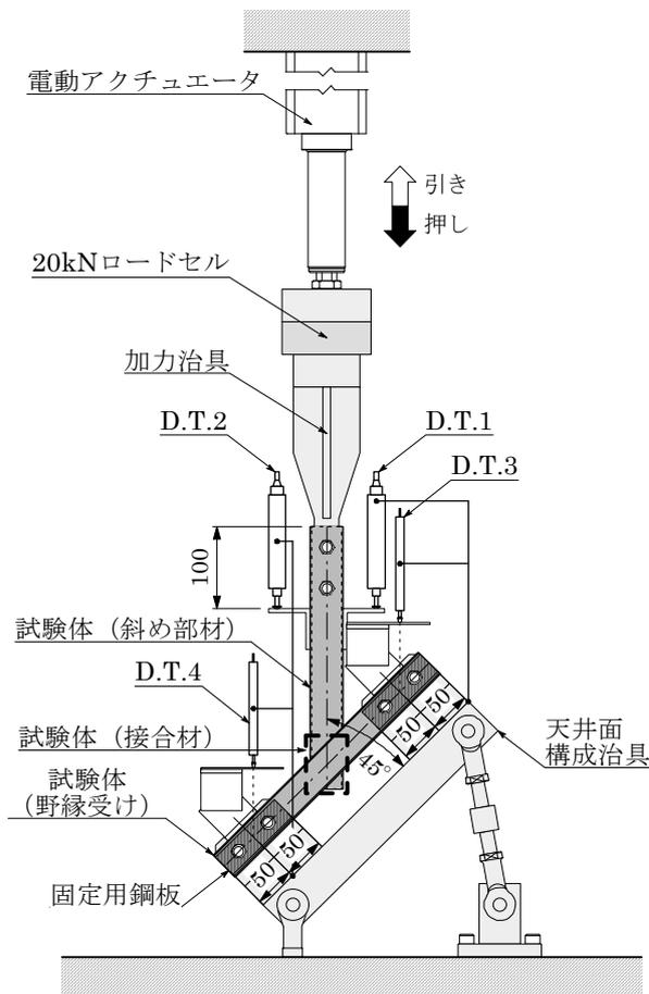
(a) 斜め部材と天井面の角度：45度
