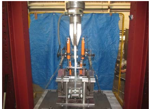
(d) 試験体の設置状況（負側）および 変位計の設置状況（D.T.1～D.T.4）
