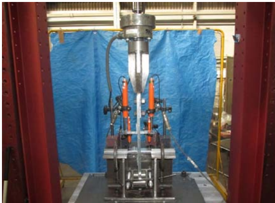
(c) 試験体の設置状況（正側）および 変位計の設置状況（D.T.1～D.T.4）
