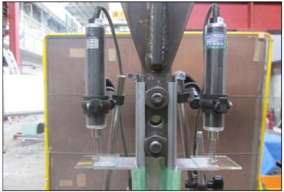
(c) 変位計の設置状況 (D.T.1, D.T.2)
