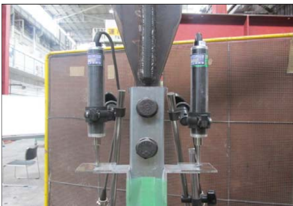
(e) 変位計の設置状況 (D.T.1, D.T.2)
