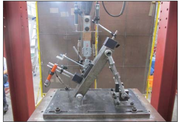
(b) 試験体の設置状況 (30度)
