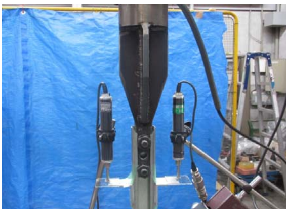
(e) 変位計の設置状況 (D.T.1, D.T.2)
