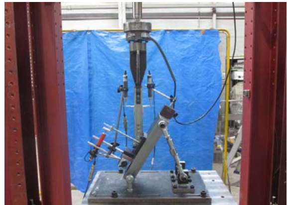
(b) 試験体の設置状況 (30度)
