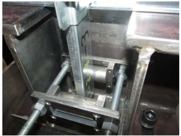
(c) 振れ止めの設置状況(加力方向:野縁受け方向)
