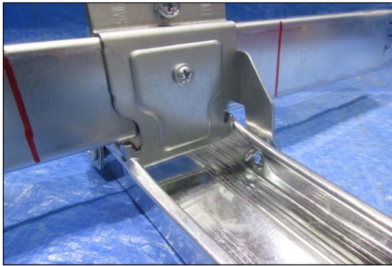
写真1.1 破壊の状態（引張方向加力）
