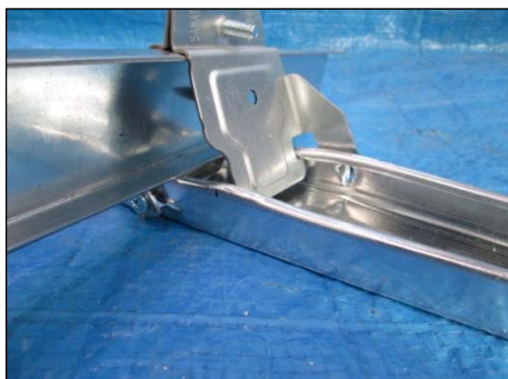
(a) 破壊の状態A（正側）
