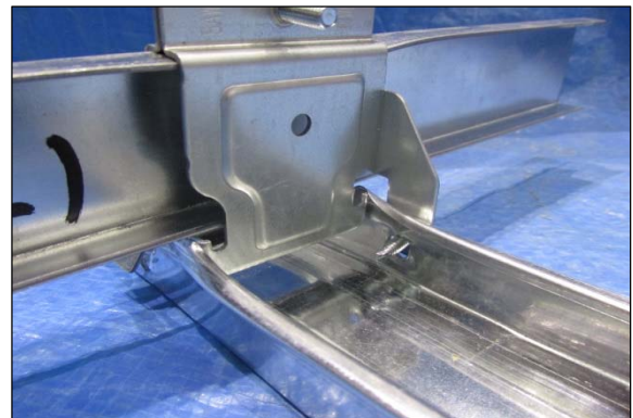
写真1.1 破壊の状態（引張方向加力）
