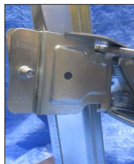
(c) 破壊の状態A (負側)
