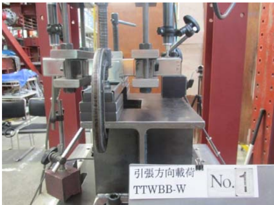
(c) 変位計の設置状況 (D.T.1, D.T.2)
