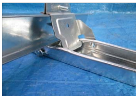
(a) 破壊の状態A (正側)
