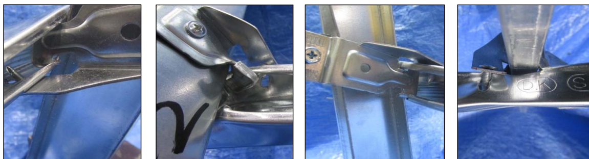
(a) 破壊の状態A（正側） (b) 破壊の状態B（正側） (c) 破壊の状態A（負側） (d) 破壊の状態B（負側）
