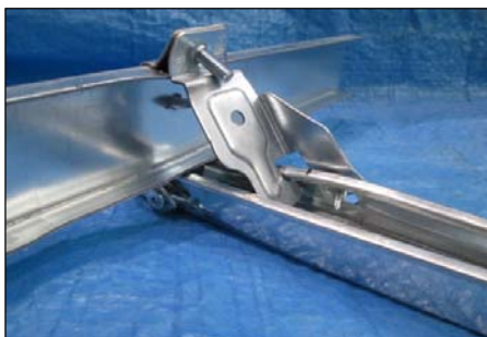
(a) 破壊の状態A (正側)
