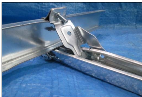
(a) 破壊の状態A（正側）
