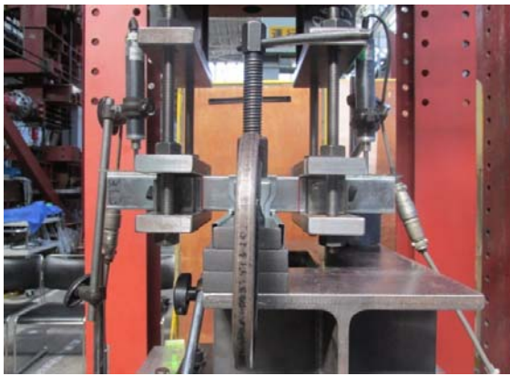
(c) 変位計の設置状況 (D.T.1, D.T.2)
