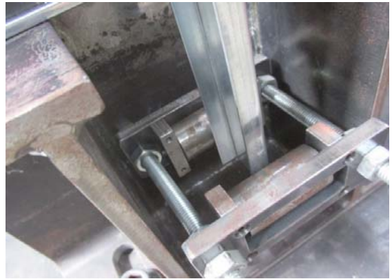
(c) 振れ止めの設置状況(加力方向:野縁受け方向)
