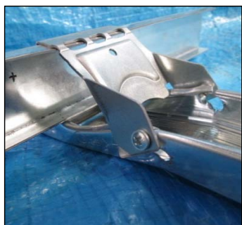
(a) 破壊の状態A (正側)
