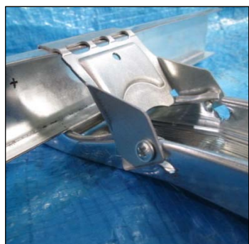
(a) 破壊の状態A（正側）
