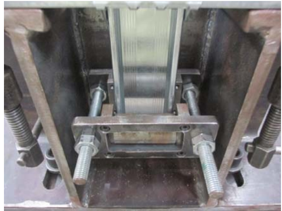
(b) 振れ止めの設置状況(加力方向:野縁方向)
