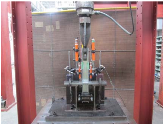
(d) 試験体の設置状況(加力方向:野縁方向) および変位計の設置状況(D.T.1~D.T.4)
