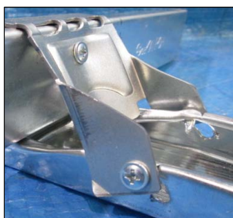
(a) 破壊の状態A (正側)
