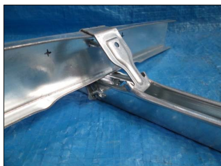
(b) 破壊の状態A (負側), 破壊の状態B
