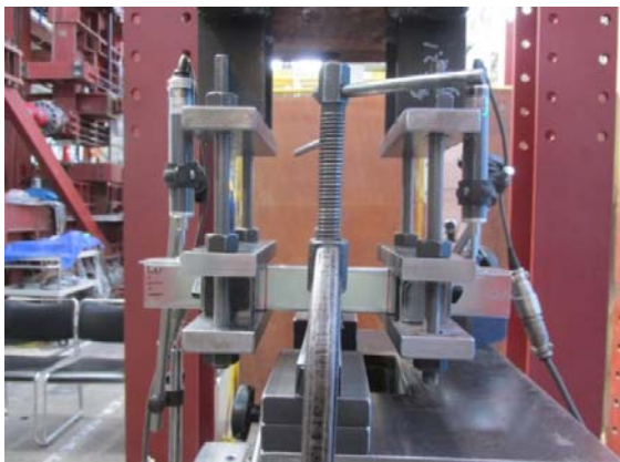
(c) 変位計の設置状況 (D.T.1, D.T.2)
