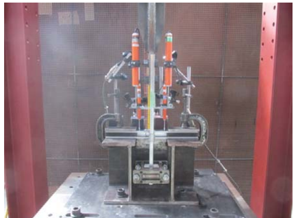
(e) 試験体の設置状況(加力方向:野縁受け方向) および変位計の設置状況(D.T.1~D.T.4)
