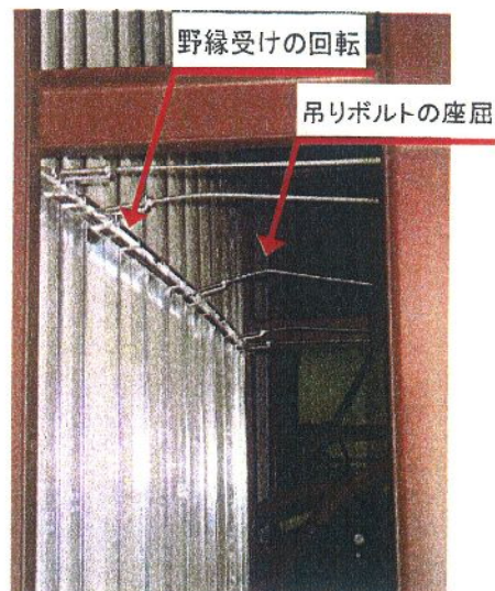
写真-8 試験後の状況（天井裏側）
